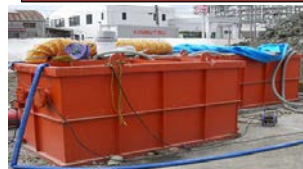
ナッチタンク内でのベンゼン浄化
